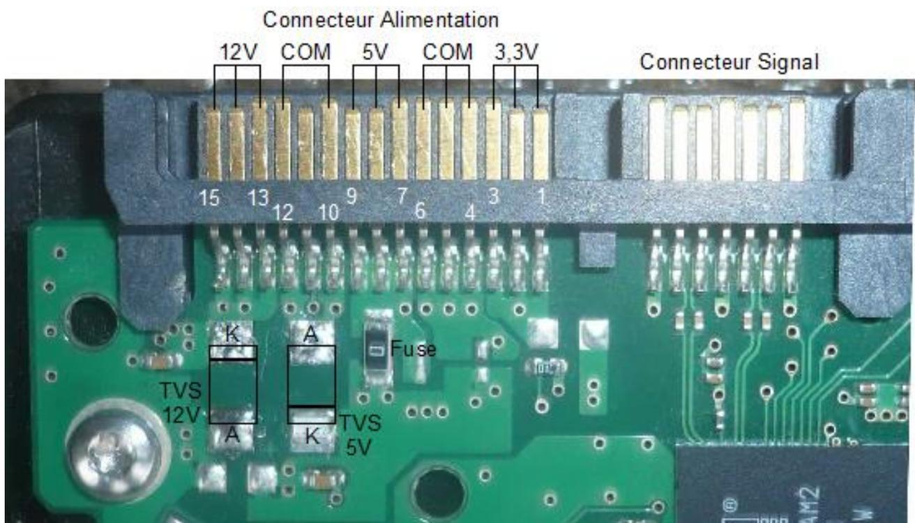
La diode TVS 12 V était câblée entre le 12V et la masse (cathode « K » au 12V et anode « A » à la masse) et la diode TVS 5V entre le 5V et la masse (cathode « K » au 5V et anode « A » à la masse).
