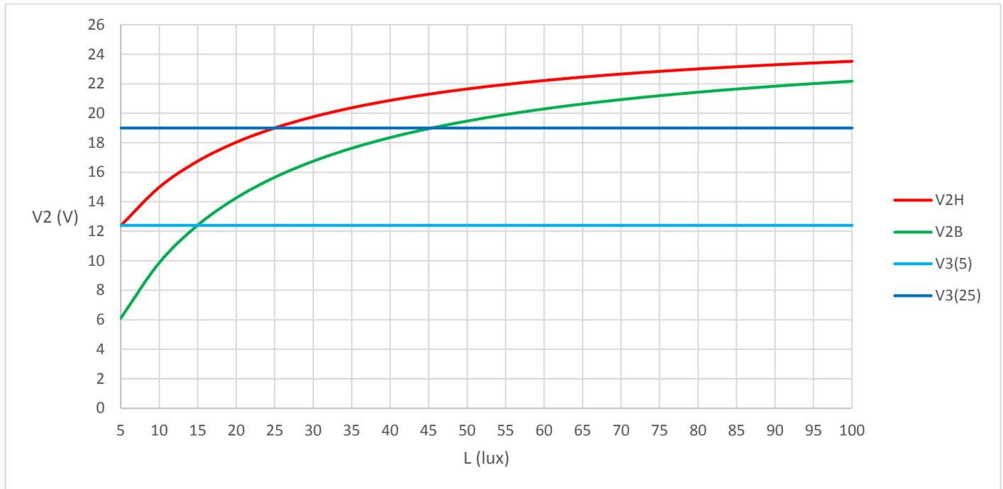
Pour  $V_3=12,4\text{ V}$ , la lampe s'allume pour  $L_a \leq 5\text{ lux}$  et s'éteint pour  $L_5 \geq 15\text{ lux}$
